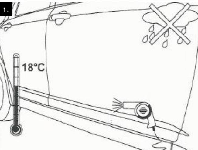
1. Montáž provádějte v prostředí při minimální teplotě 18°C. Pokud je teplota nižší jak +18°C, lze dosedací plochy zahřát např. fénem. Lepení neprovádějte v dešti.
