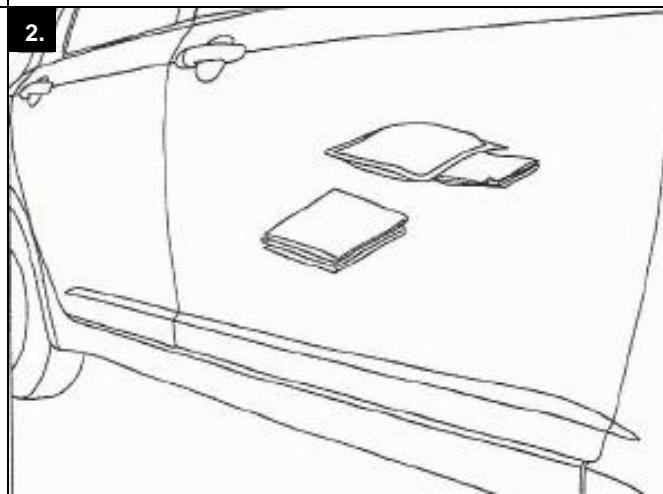
2. Plochy pro lepení musí být suché a zbavené nečistot, tyto je třeba dále odmaštít přiloženým odmašťovacím ubrouskem. Odmašťovací ubrousek je napuštěn isopropanolem, který je vysoce hořlavý, proto při montáži nekuřte!
