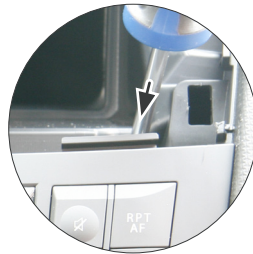
Ziehen Sie das OEM Radio aus dem Einbauschacht
