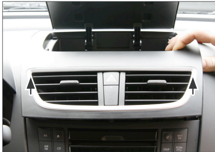
Ziehen Sie die Einheit mit den Lüftungsgittern nach oben (siehe Pfeile)
