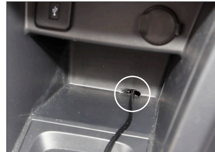
Bohren Sie ein Loch in die Rückwand der unteren Ablage und führen Sie das Inbay® Stromkabel durch dieses.
