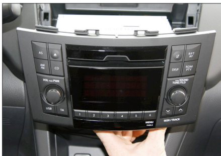
Ziehen Sie das OEM Radio aus dem Einbauschacht
